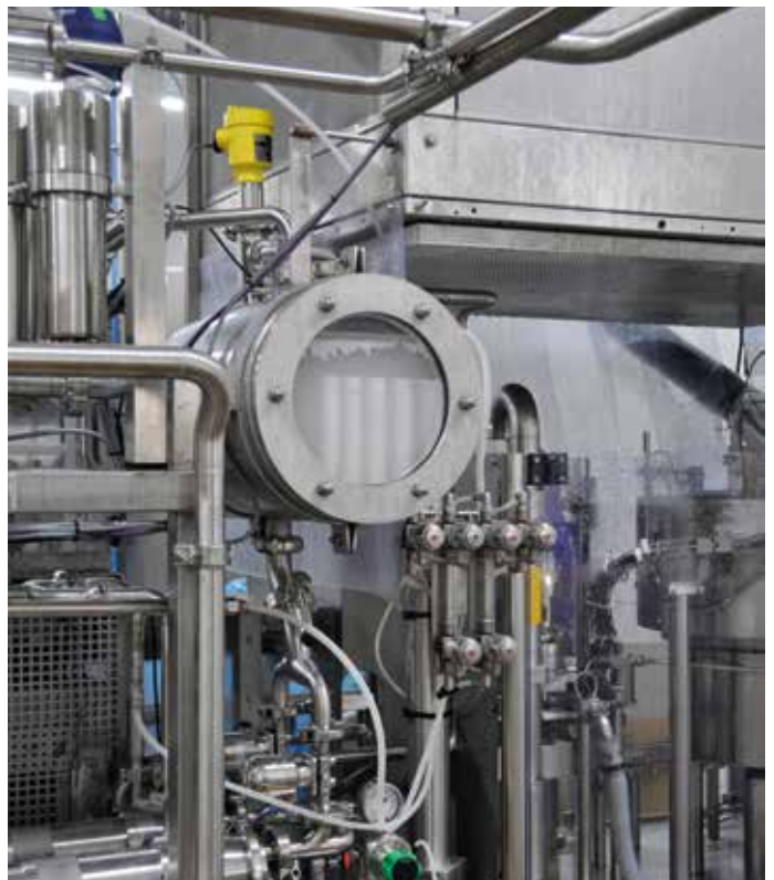
Le VEGAPULS 64 permet une mesure fiable, même dans les cuves équipées de structures internes, comme un agitateur par exemple.
