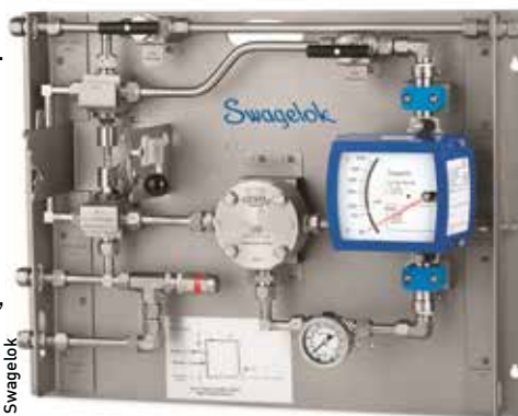
Figure 3. Un système à boucle rapide peut fonctionner avec un débit plus élevé qu'un système à ligne simple, car la plus grande partie du fluide est renvoyée dans le process.
