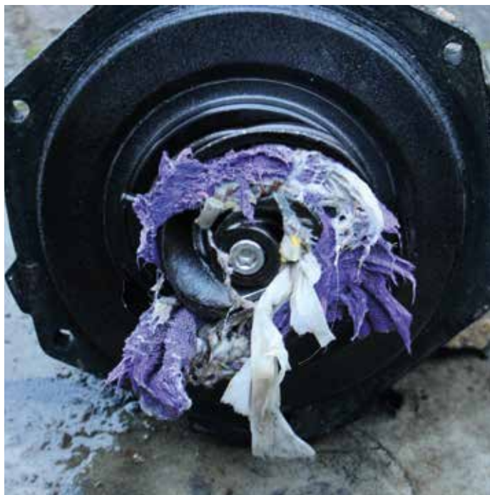
Roue d'une pompe centrifuge encombrée par des corps étrangers.
